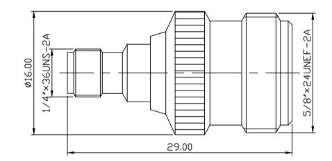
MATERIAL : BODY-BRASS SLEEVE-BRASS INSULATOR-TEFLON CONTACT-BERYLLIUM COPPER FINISH : BODY-NICKEL PLATING SLEEVE-GOLD PLATING OVER NICKEL CONTACT-GOLD PLATING OVER NICKEL
